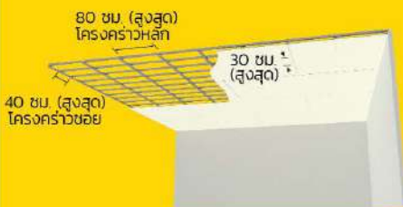
การติดตั้งบนโครงคร่าวเหล็ก
