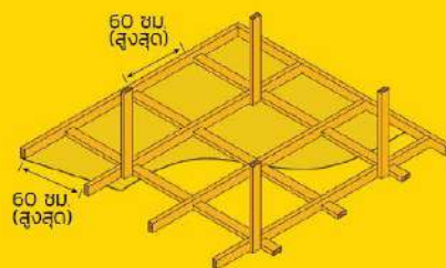
การติดตั้งบนโครงคร่าวไม้
