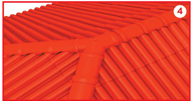
การวางกรอบสันตะเข้ตัวสุดท้ายของทั้งสองด้านที่บรรจบกันที่แนวสันหลังคา ต้องตัดแต่งให้แนบสนิทกัน ดูสวยงาม
